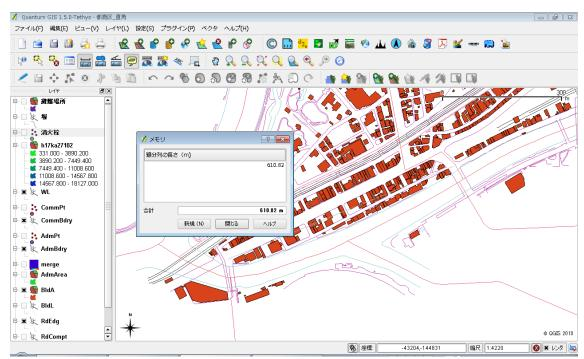
2. 緯度経度系のプロジェクト上に、緯度経度系のファイルを開いて測ると、0.01 度 (= 約 1.000m)。
